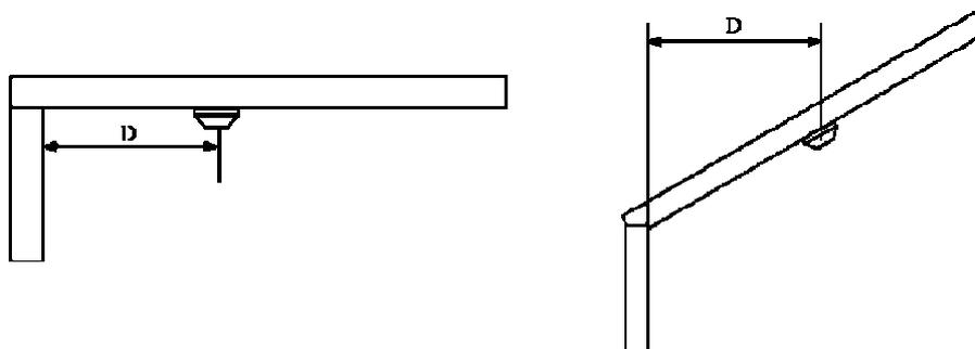
**Figura A.2.3 – Identificación de D (Distancia entre detector y punto del techo o cubierta)**
