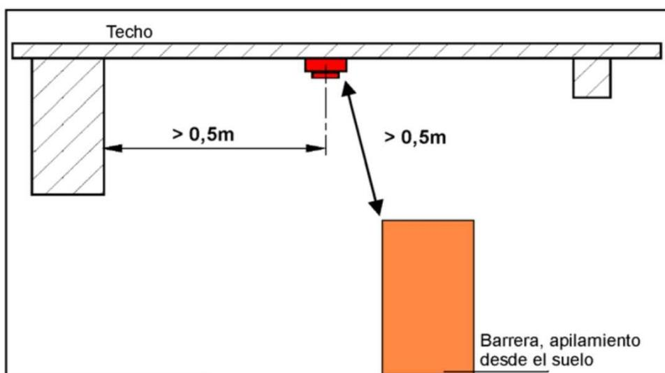
Figura A.10 – Ilustración de distancia entre el detector y un obstáculo
