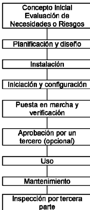
**Figura 1 – Diagrama de flujo ideal del sistema**
